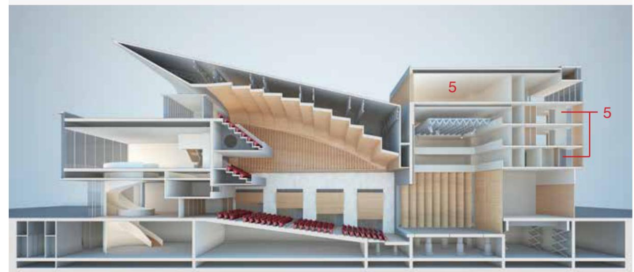
La ripartizione è utile per dotare il teatro di una volumetria che sia ampia e capace di arrivare a 10 mc/persona nell'uso per la sinfonica (la soglia massima è di 20 mc/p) quindi capace di realizzare un tempo di riverberazione con un periodo di 1,7-2,3 secondi. Sapendo che per l'opera sarebbero sufficienti 7 mc/p e per il cinema-teatro 4 mc/p con riverberazioni inferiori (1,4-0,8 sec.)
