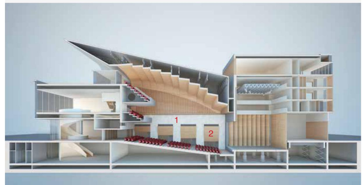
Lo “strumento” costituisce la controfaccia della sezione mistilinea della copertura in carpenteria metallica e si muove in forma parzialmente autonoma verso l’interno per realizzare la migliore configurazione di controllo del suono.
